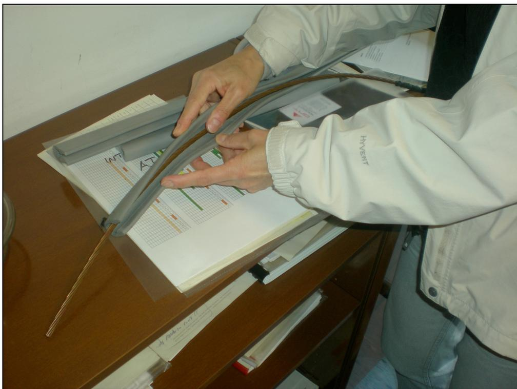
**Figura 13** - Profilo in gomma EPDM da applicare sui conduttori in tensione omologato da ENEL (Foto: E. Bassi).
